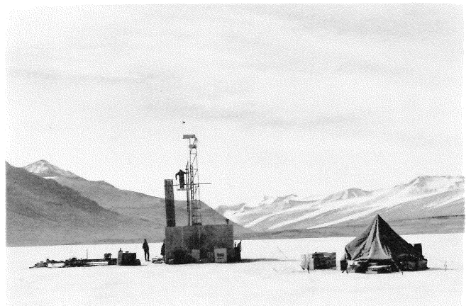
写真—5 バンダ湖氷上に組立てられたボーリングのやぐら、サンプルは右のテントに運ばれ記載される。
